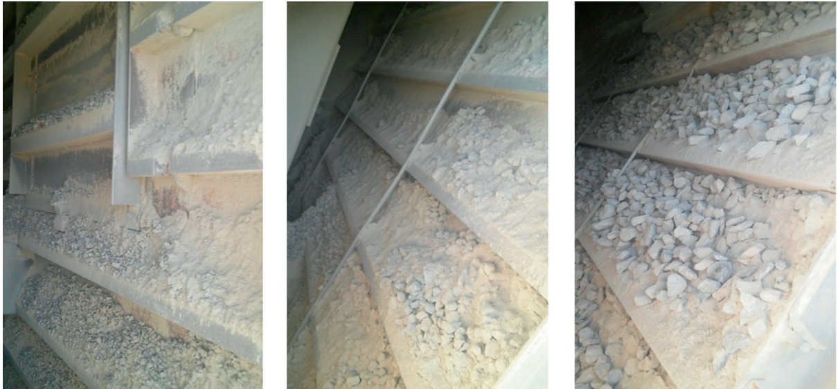
Рисунок 3 — Фракційна сегрегація в гарячих бункерах асфальтобетонного заводу
