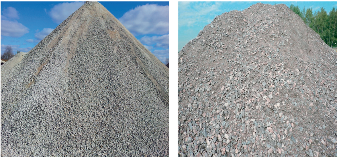
Рисунок 2 — Фракційна сегрегація при неправильному відвантаженні та зберіганні мінеральних матеріалів
